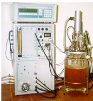
Laccaseproduktion mit Trametes versicolor im Bioreaktor
