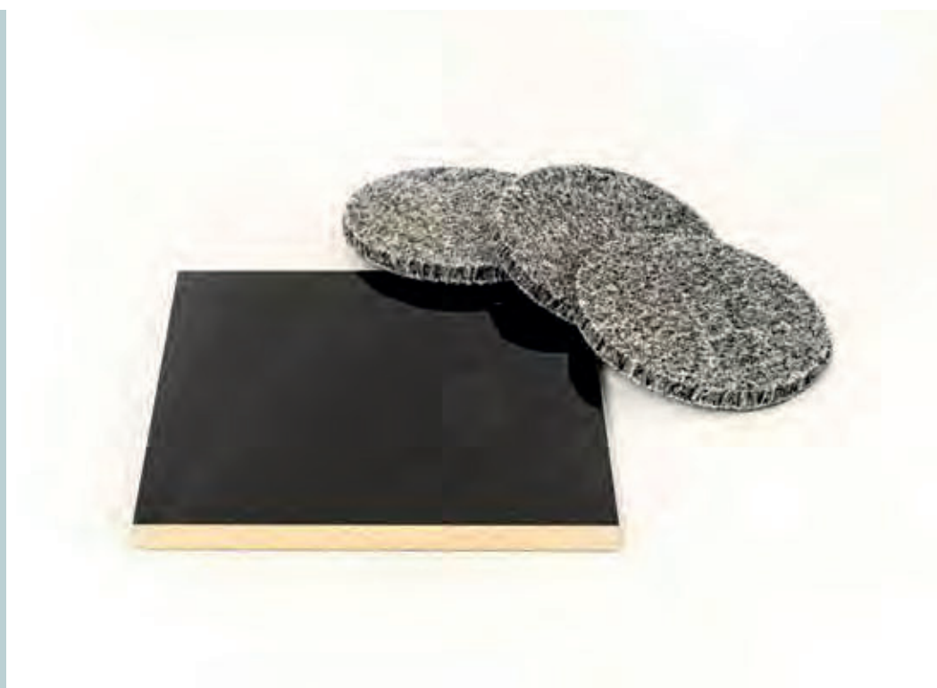
Abb. 2: Neue Scheuermaterialien sowie neue Referenz-Hochglanzoberfläche zur Kalibrierung der Scheuermaterialien
