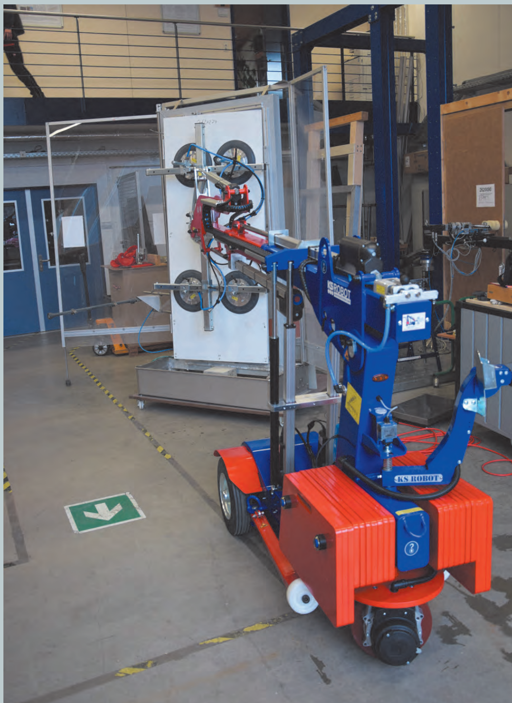
Abb. 2: Neues Gerät zum Transport von Fenstern und Türen
