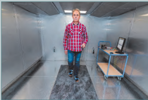
Abb. 1: Begehen eines Bodenbelags durch eine Person und Ermittlung der Personenaufladung (Personenspannung U_A ) nach EN 1815 bzw. nach ISO 6356 (links) und apparativer Begetest (Estameter, TFI 2005, rechts)
