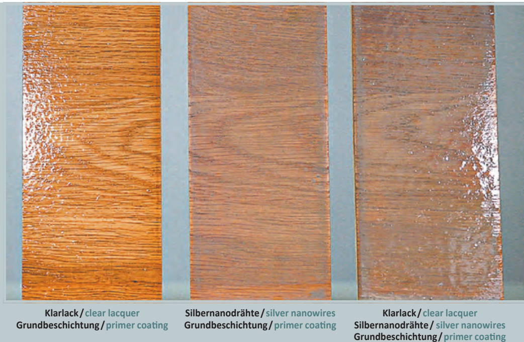
Abb. 2: Fotografische Abbildung von Beschichtungssystemen mit und ohne Silbernanodrähte auf Eichenparkett
