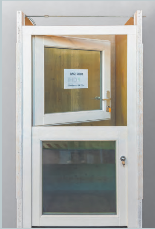
Abb. 1: 2-flügelige Mustertür im Hochwasserprüfstand
