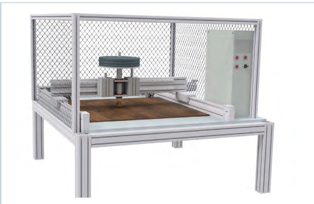
Abb. 1: Prüfgerät für die Simulation des Verschiebens von Möbelfüßen auf Fußböden nach EN ISO 16581
