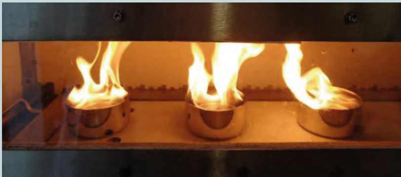
Abb. 1: Heptanverbrennung in 3 Brennschalen am Fußbodenprüfstand Radiant-Panel
