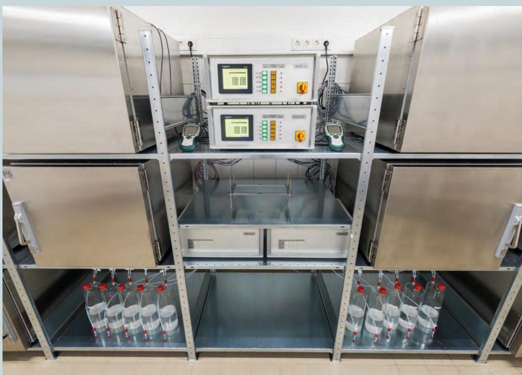
Abb. 2: Modular aufge- bautes Prüfkammersystem bestehend aus vier 0,225 m³ Edelstahlprüf- kammern für Emissions- prüfungen gemäß ausge- wählter internationaler Prüfstandards
