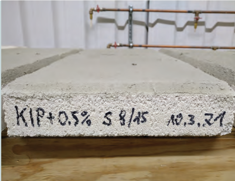
Abb: 1: Leichter Kalk-Innenputz mit 0,5 % Holzspänen auf Gasbeton
