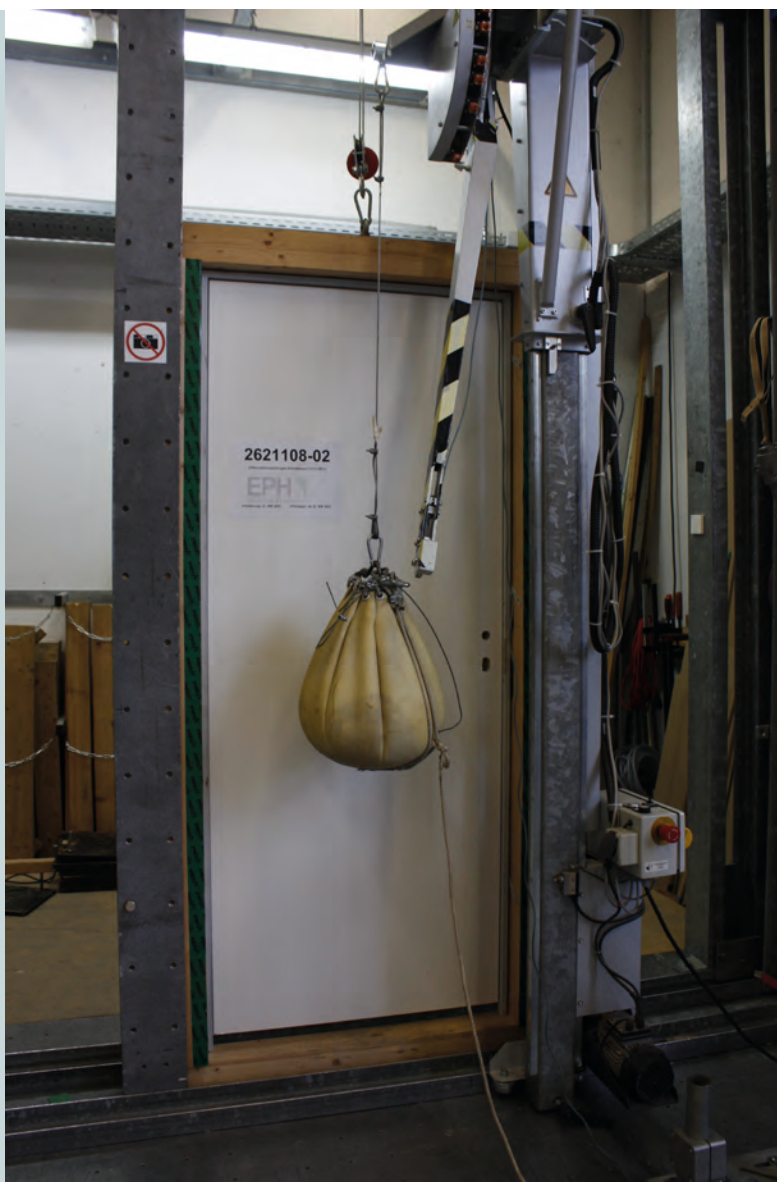
Abb: 1: Prüfung einer Innentür auf weichen und schweren Stoß nach DIN EN 949
