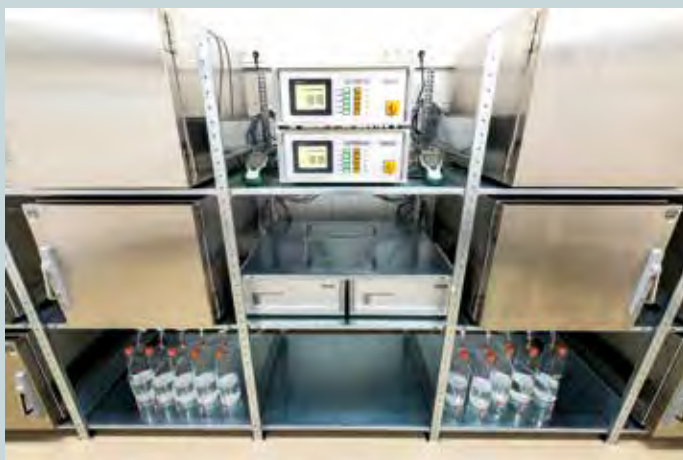
Abb. 2: Modular aufgebautes Prüfkammersystem bestehend aus 0,225 m 3 Edelstahlprüfkammern für Emissionsprüfungen gemäß ausgewählter internationaler Prüfstandards
