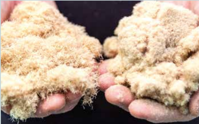
Abb. 1: Am IHD hergestellter Recyclingfaserstoff mit unterschiedlicher Feinheit
