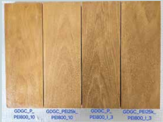
Abb. 1. Demonstratoren von Oberflächen mit isocyanatfreien Polyurethanen (NIPU) auf Buchenholz. Es handelt sich um Mischungen aus einem Carbonat (GDGC) und verschiedenen Aminen (P, PEI800/25k und I)
