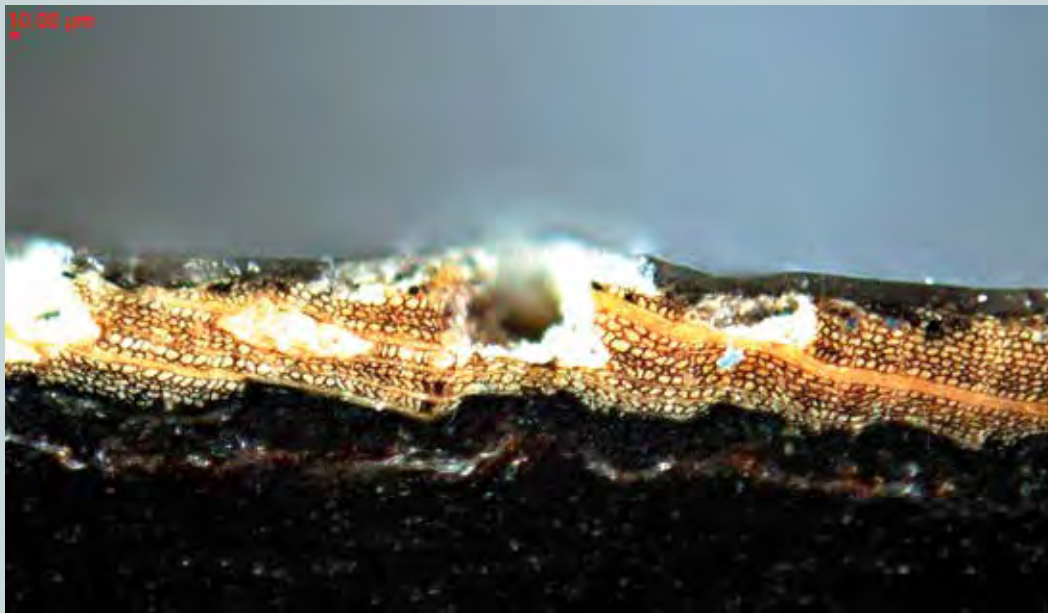
Abb. 1: Mikroskopische Aufnahme des Querschnitts eines Zierelements auf Basis von Nussbaumfurnier nach 12-monatiger Belastung in kontinental-aridem Wüstenklima bei 10-facher Vergrößerung; Rissbildungen in Lack und Furnier sowie Lackabplatzer erkennbar
