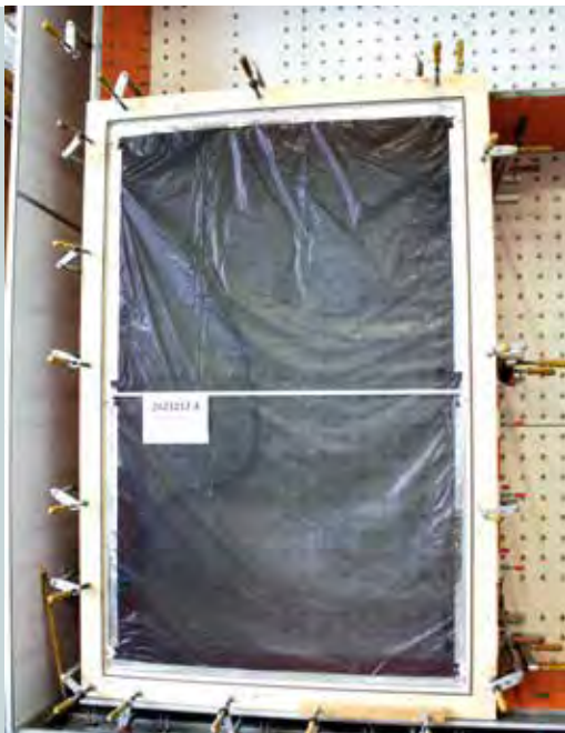
Abb. 1: Windlastprüfung eines Insektenschutzes
