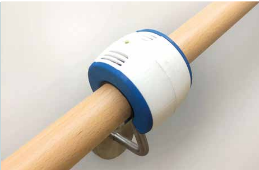
Abb. 1: Demonstrator einer Hygienehilfe für Handläufe mit integriertem Reinigungsmodul
