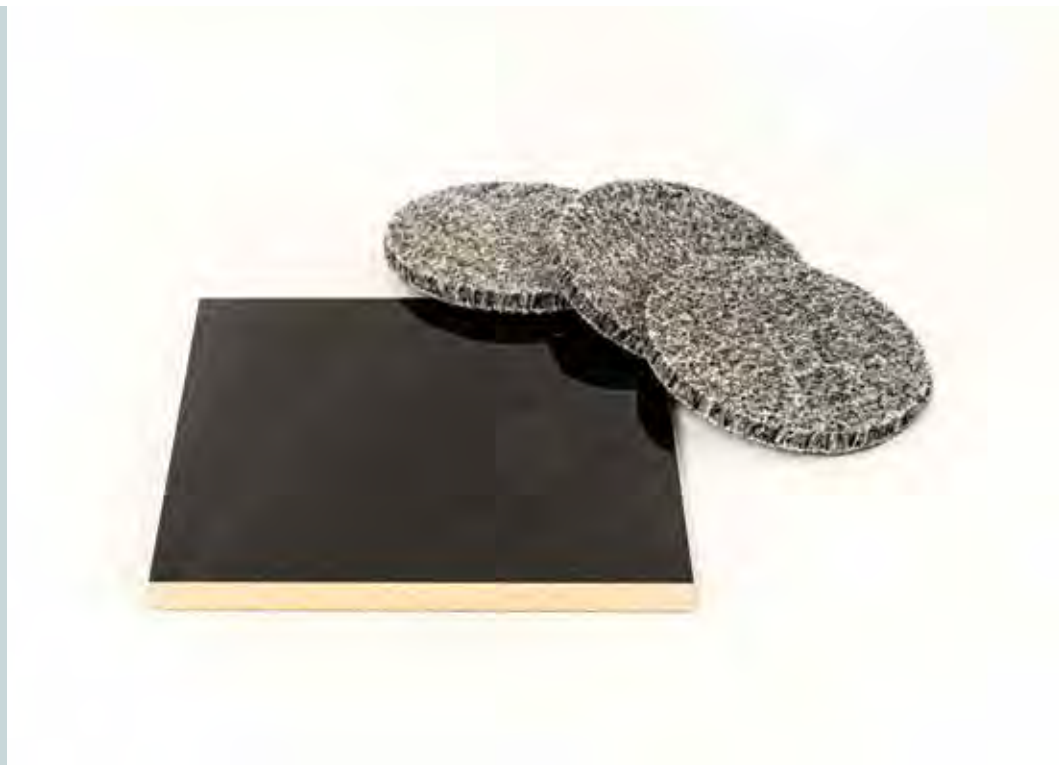
Abb. 2: Neue Scheuermaterialien sowie neue Referenz-Hochglanzoberfläche zur Kalibrierung der Scheuermaterialien Fig. 2: New scrub materials and a new reference high-gloss surface for calibrating the scrub materials
