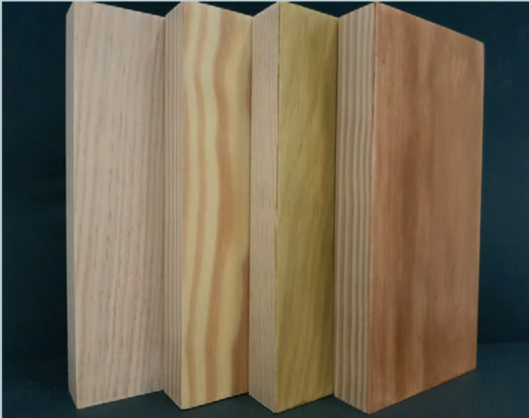
Abb. 1: Fichtenholz-Prüfkörper im Vergleich: unbeschichtetes Holz sowie Beschichtungen auf Basis von Chitosan, Chitosan-Kupfer und Chitosan Silber
