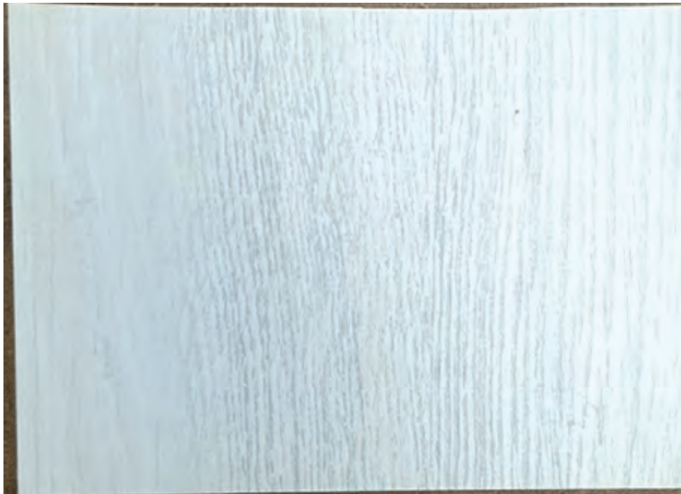
Abb. 1: Mit farblosem NIPU getränktes Dekorpapier auf MDF
