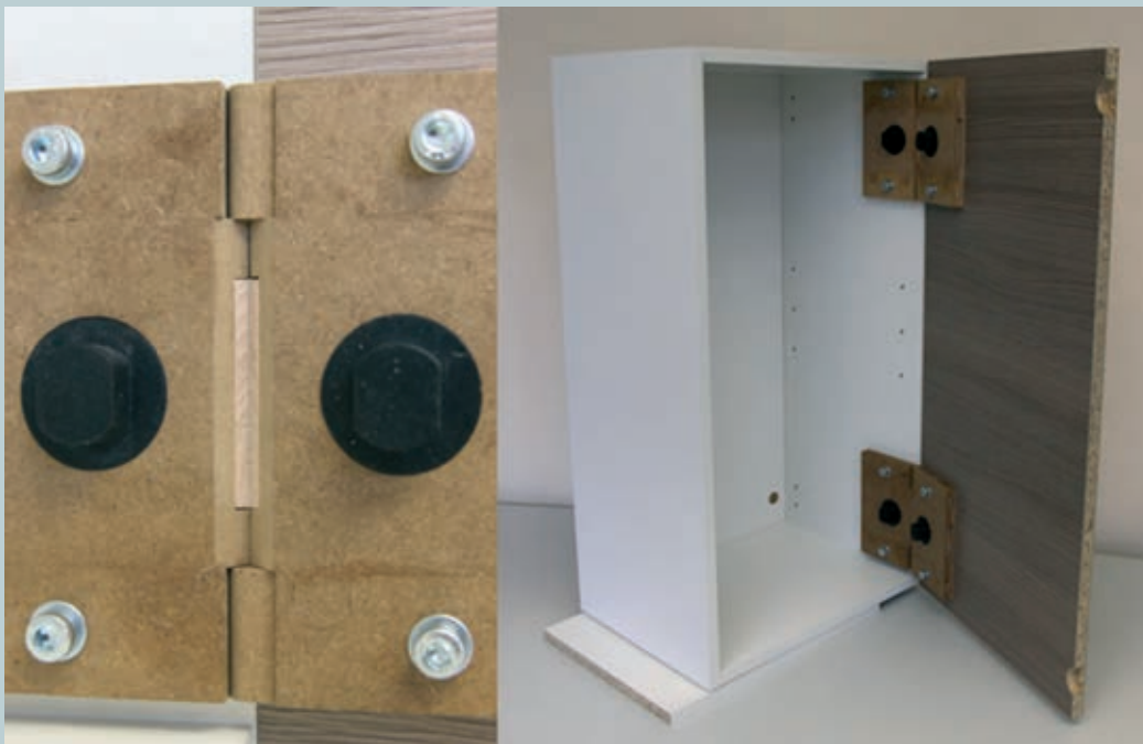
Abb. 2: Demonstrator des Textilscharniers; links: Detailaufnahme im Möbel, rechts: Einbausituation des Scharniers
