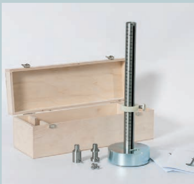
Abb. 1: Stoßfestigkeitsgerät Kleine Kugel Typ 70-350 zur Prüfung von Laminatfußböden nach EN 17368
