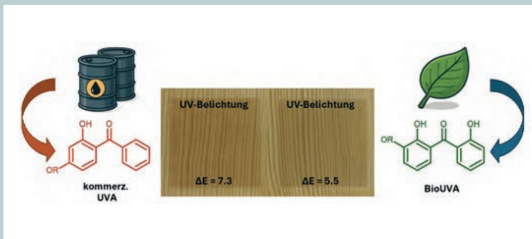
Abb. 2: Leistungsvergleich von beschichtetem Kiefernholz mittels Belichtungsprüfung angelehnt an DIN EN ISO 16474-2 mit verbesserter Farbechtheit.
