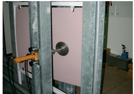
Prüfung von absturzsichernden Bauteilen
