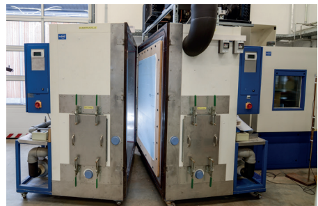
Differenzklimaprüfung an Fenstern
