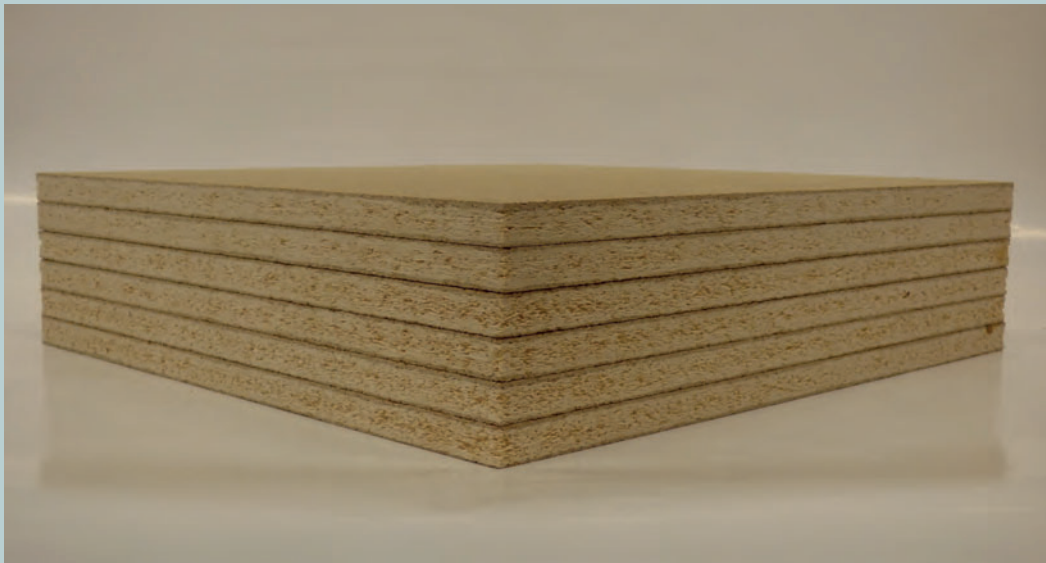
Abb. 1: Hergestellte Spanplatten (Rohdichte 500 kg/m 3 ) unter Nutzung von Spänen mit veränderten Anschnittwinkeln (von oben nach unten je 2 Muster mit 0°, 15° sowie 30° Anschnittwinkel der eingesetzten Späne)
