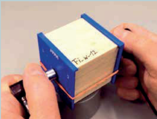
Abb. 1: Referenzprüfkörper (50×50×50) mm 3 mit definierter Fäuleschädigung (12 Wochen Inkubation)
