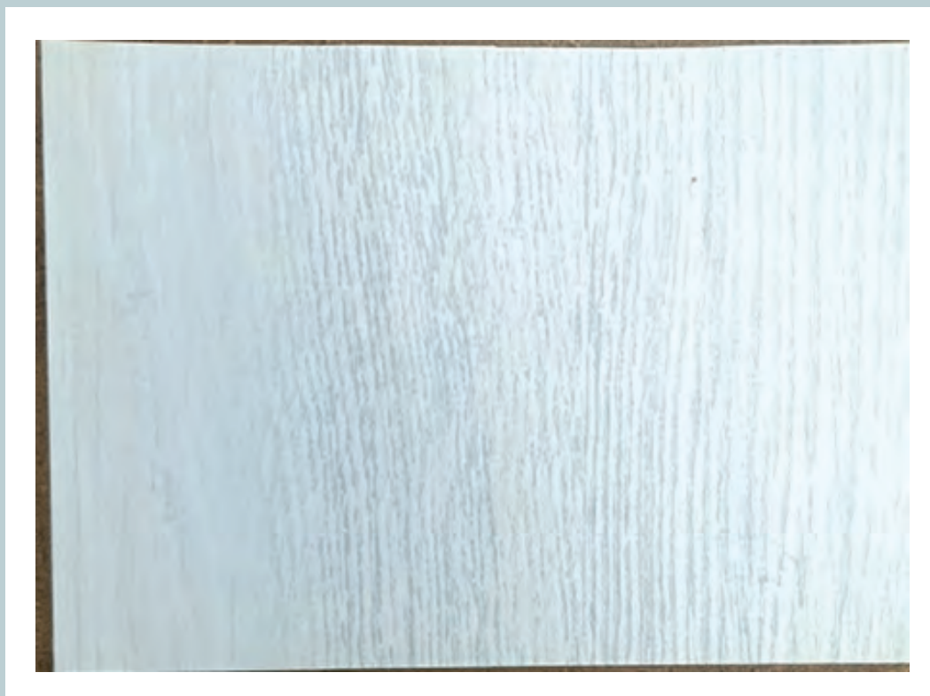
Abb. 1: Mit farblosem NIPU getränktes Dekorpapier auf MDF
