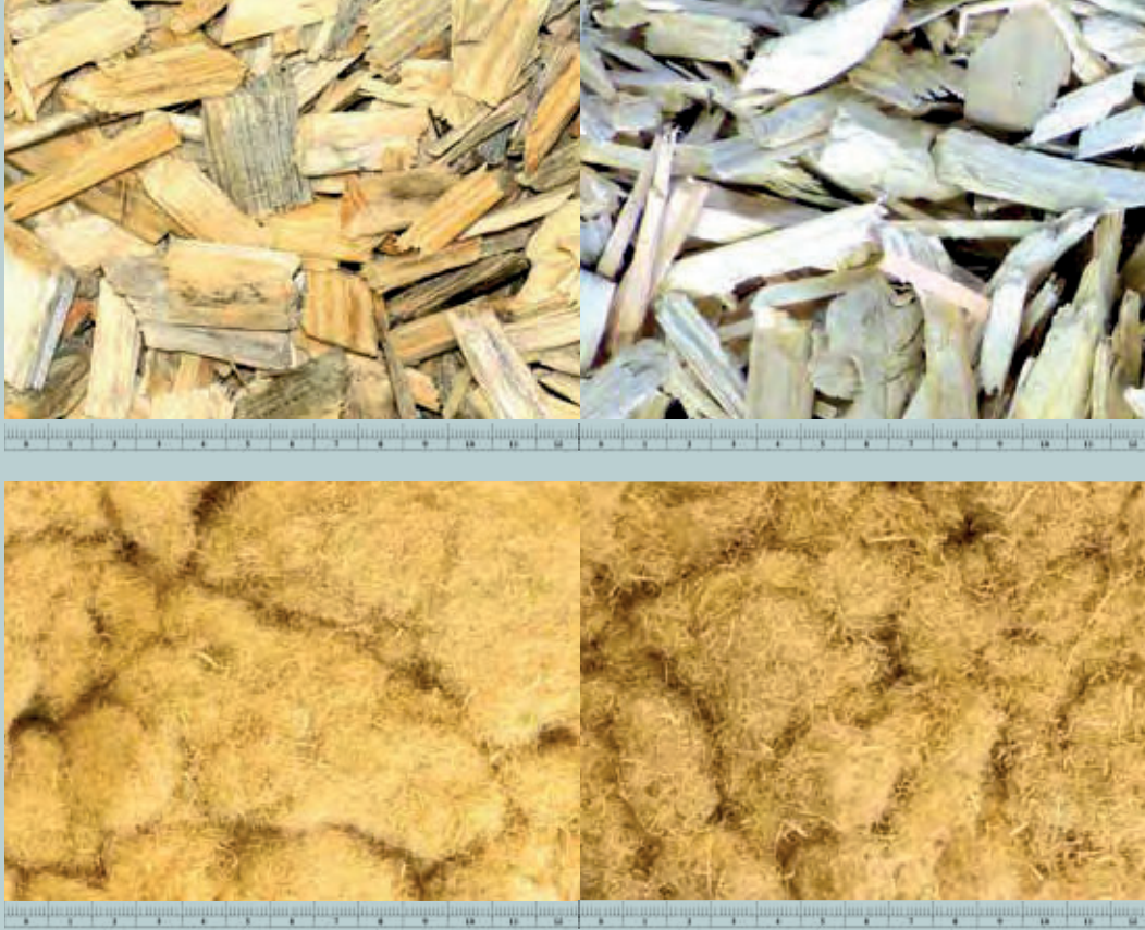
Abb. 1: Gehacktes Ausgangsmaterial (oben, von links nach rechts: Frischholz, Altholz) und daraus im modifizierten TMP-Prozess des IHD hergestellter Faserstoff (unten, von links nach rechts: 100% Frischholz, 100% Altholz).
