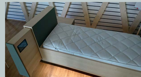
Abb. 2: Bett mit sensorisierter Matratze und Datenerfassungs- und -auswerteeinheit im Kopfteil
