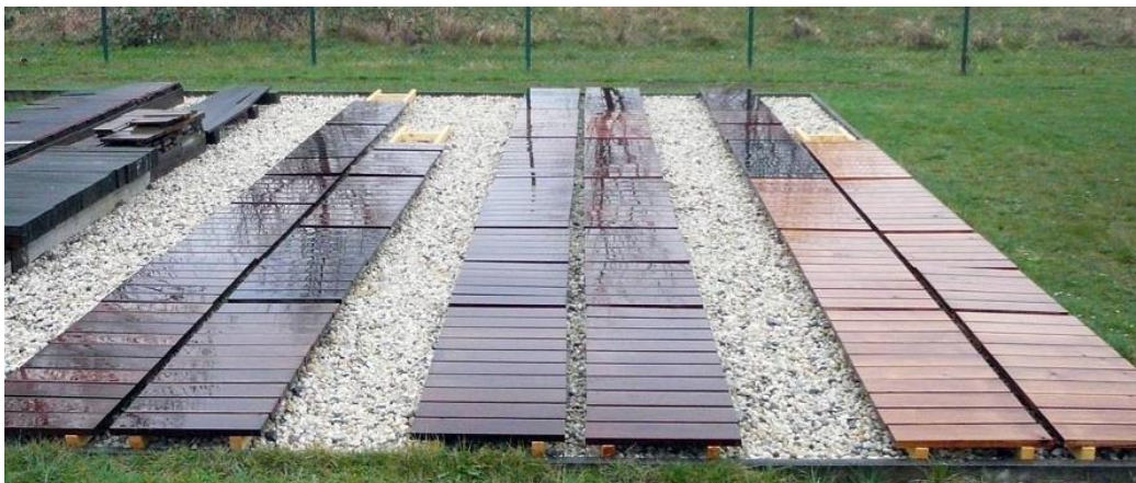
Abb. 1: TMT-Varianten in Bewitterung auf dem IHD-Freilandversuchsfeld (regennass)
