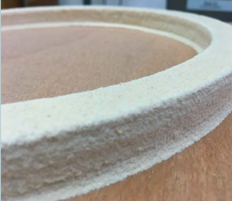
Abb. 2: Aus 20 Schichten mittels selektivem Heißpressen gefertigter Ring
