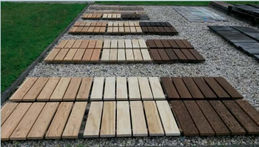
Abb. 1: Freilandprüfung in Gebrauchsklasse 3.2
