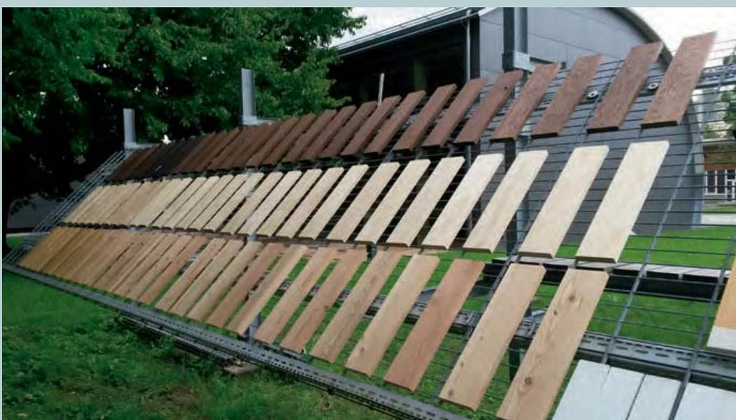
Abb. 2: Freilandprüfung mit 45°-Bewitterung, nordexponiert
