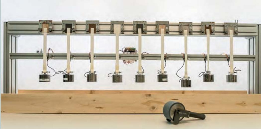
Abb. 2: Teststand zur Prüfung der Lebensdauer der Haftverbindung in Anlehnung an den FINAT FTM 8-Test
