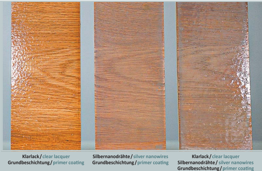
Abb. 2: Fotografische Abbildung von Beschichtungssystemen mit und ohne Silbernanodrähte auf Eichenparkett Fig. 2: Photographic image of coating systems with and without silver nanowires on oak parquet flooring
