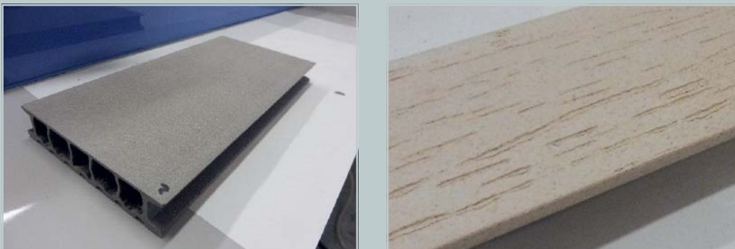
Abb. 1: Oberflächen auf zwei WPC-Substraten – Hohlziele (WPC-02 50 % PP/50 % Holz, links) und Vollziele (WPC-07 30 % PE/70 % Holz, rechts)
