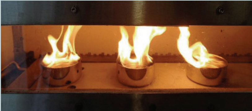
Abb. 1: Heptanverbrennung in 3 Brennschalen am Fußbodenprüfstand Radiant-Panel
