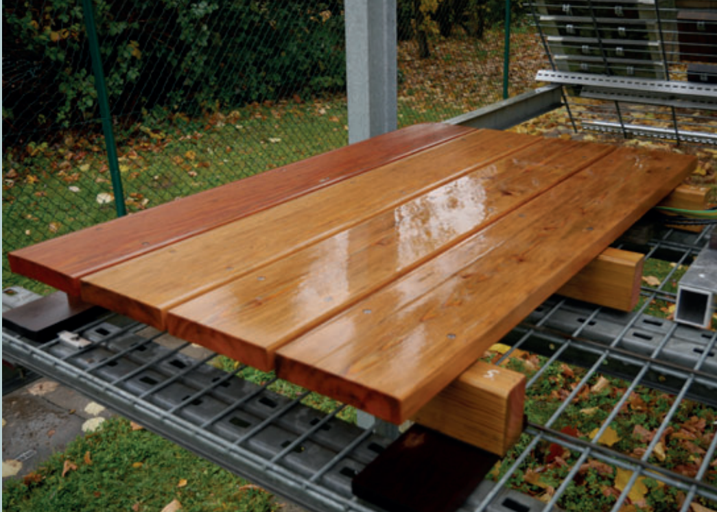
Abb. 2: Wasserfilm bei 2 % Gefälle nach Regen
