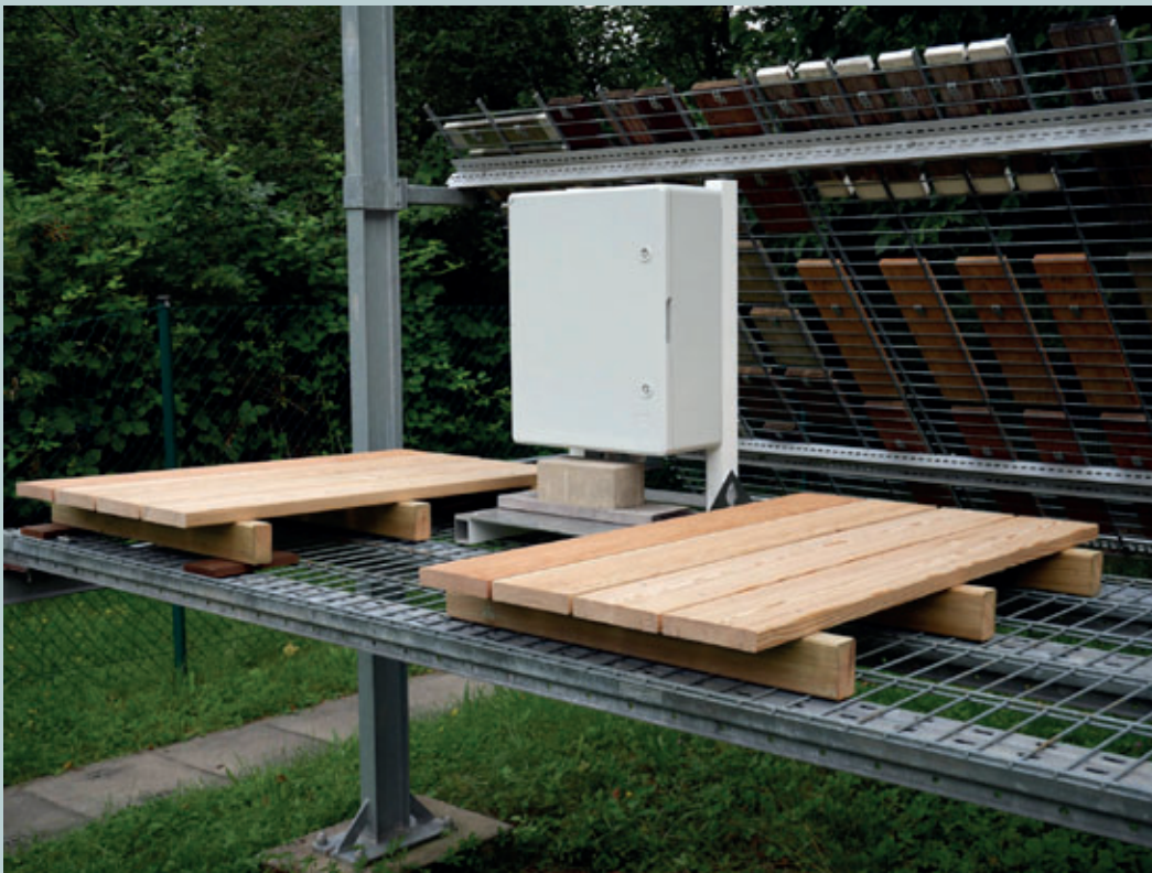
Abb. 1: Belagsroste mit 0 % und 2 % Gefälle im Test
