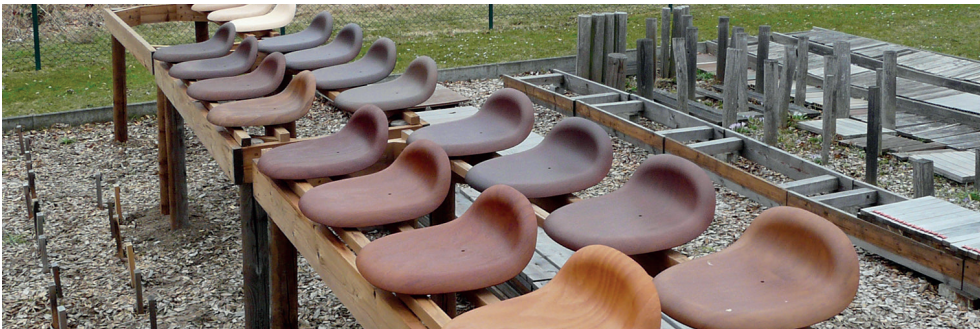
Sitzelemente (Gubi barstool) aus thermisch modifizierten Furnieren verschiedener Behandlungsstufen in der Freibewitterung (Thermische Behandlung: IHD und OWI, Herstellung: REHOLZ)
