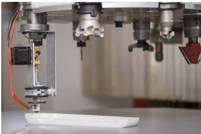
Abb. 2: 3D-Druck auf Bearbeitungszentrum
