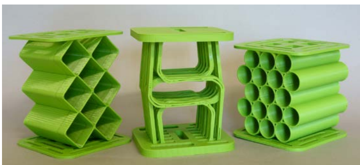
Abb. 3: 3D-gedruckte Federelemente für Anwendungen im Möbelbereich
