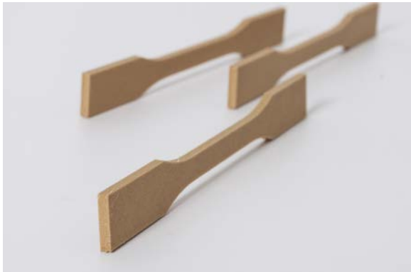
Abb. 1: Zugprüfkörper aus Holz-Kunststofffilament
