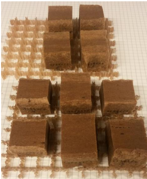
Abb.1: Proteingebundene MDF nach Wasserlagerung
