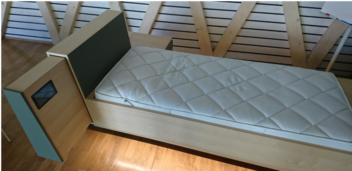
Abb. 2: Bett mit sensorisierter Matratze und Datenerfassungs- und –auswerteeinheit im Kopfteil
