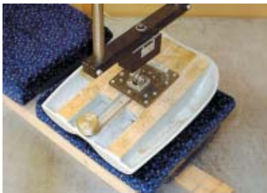
Ermittlung der Polstercharakteristik an einem Fahrgastsitz für Schienenfahrzeuge
