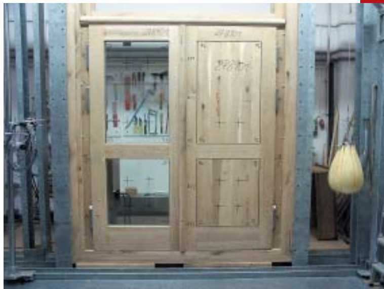
Prüfung einer zweiflügeligen Holztür auf Einbruchhemmung (Widerstandsklasse WK3) (BV: Stadtmuseum Dresden)
