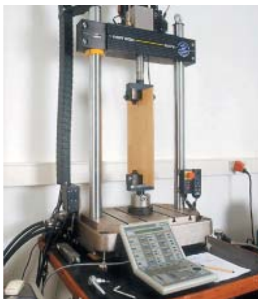
Wechselastprüfung an Querfugen von Laminatclickverbindungen
