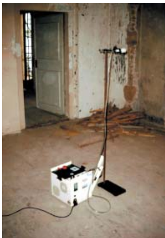
Probenahme zur Bestimmung der Holzschutzmittelkonzentration in der Raumluft
