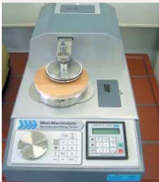
Bestimmung der Mar-Resistance von Oberflächen mittels Martindale-Gerät
