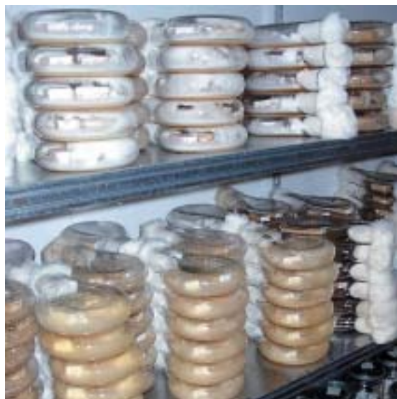
Prüfansätze zur Bestimmung der Dauerhaftigkeit von Holz gegenüber Basidiomyzeten nach EN 113
