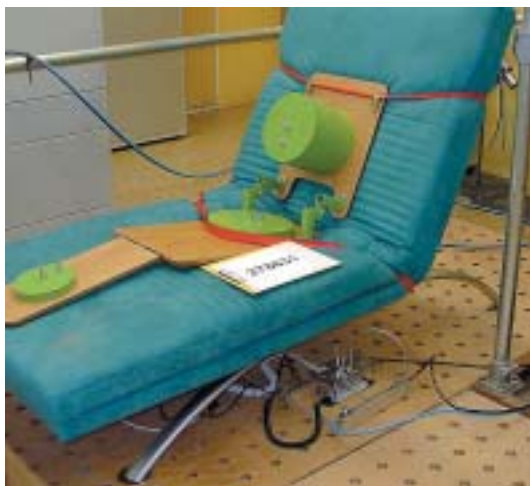
Dauerfunktionsprüfung eines elektromotorisch verstellbaren Sitz-/Liege-Möbels
