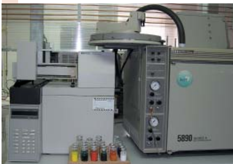
Headspace-Gaschromatographie zur Bestimmung des VOC-Gehaltes von Dispersionsfarben
