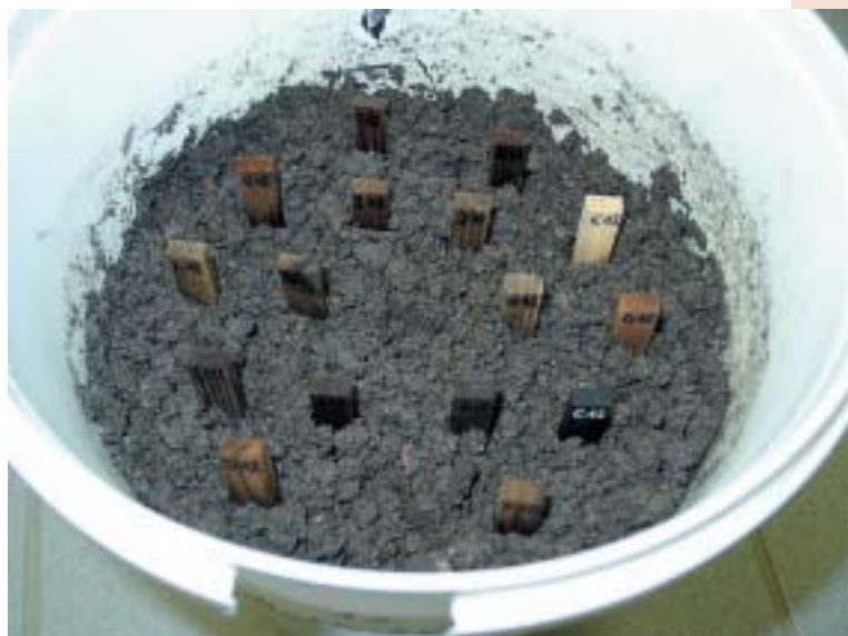
Moderfäuleprüfung nach DIN EN 807 als Basis für Bestimmung der natürlichen Dauerhaftigkeit gemäß DIN EN 350-1
