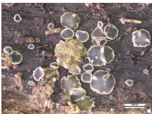
Abb. 1: Fruchtkörper und Pilzmyzelien auf Kiefernspintholz nach 2 Jahren Exposition im Erdkontakt
