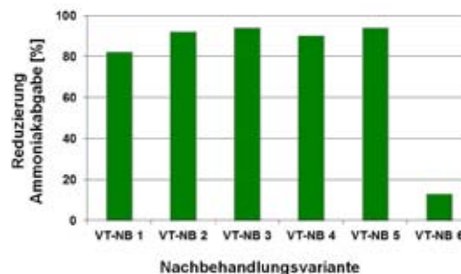
Abb. 3: Reduzierung der Ammoniakabgaben auf Basis der nicht nachbehandelten Proben in [%] nach Vakuum-Temperatur-Nachbehandlungen über 24 bzw. 48 h
