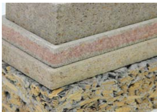
Abb. 1: Beispiele unterschiedlicher zementgebundener Spanplatten (CBPB)
