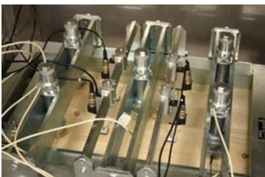
Abb. 3: Mehrschichtparkettprüfgerät während der Prüfung eines Vollholz-Prüfkörpers (Prüfkörper, Einbau in eine Klimazelle, Integration von Kraft- und Wegsensoren)
