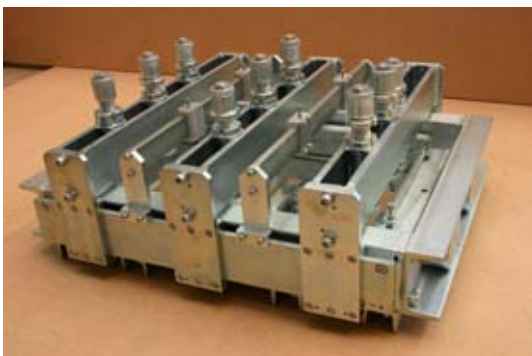
Abb. 2: Prototyp des Mehrschichtparkettprüfgerätes mit Rahmen zum Einbringen des Prüfkörpers und beweglichen Traversen für die Befestigung von Kraft- und Wegsensoren
