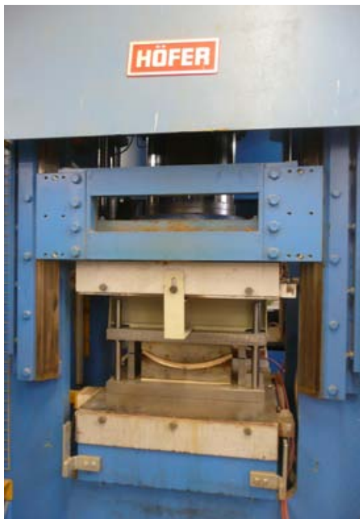
Abb. 2: Laborpresse mit eingebautem Formteilpresswerkzeug im Technikum des IHD
