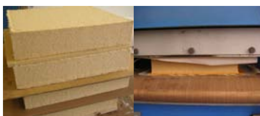
Abb. 1: Labortechnischer Herstellungsprozess von in einem Arbeitsgang beschichteten und verpressten MDF
