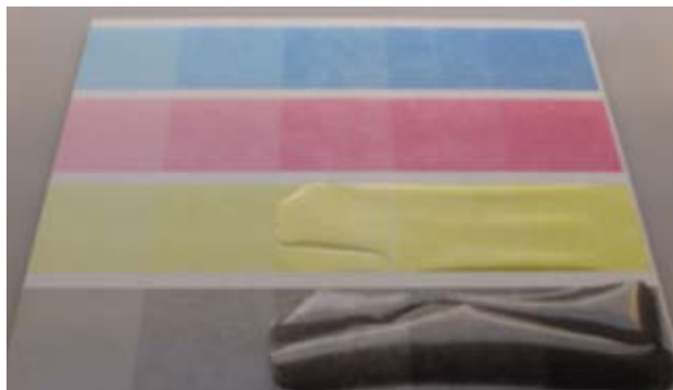
Abb. 2: Abplatzungen des Melaminoverlays in Abhängigkeit von der Intensität des Tintenauftrags
