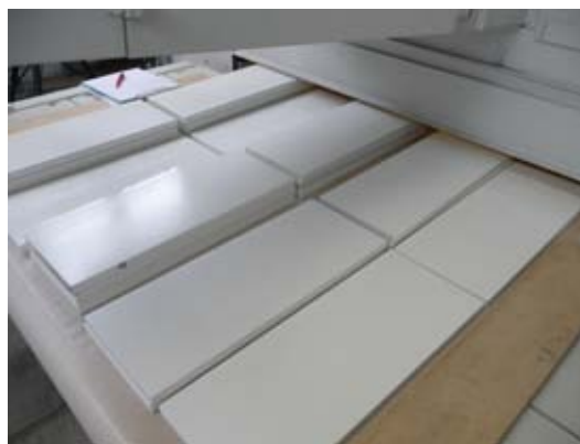
Abb. 2: HF-Trocknung lackierter Oberflächen
