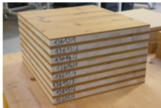
Abb. 1: Dreilagige Massivholzplatten aus Fichtenholz, Qualität SWP/1 (Verwendung im Trockenbereich), unter Verwendung des Cellulosederivat-Klebstoffs HEC-GLY für die Lagen- und Fugenverklebung
