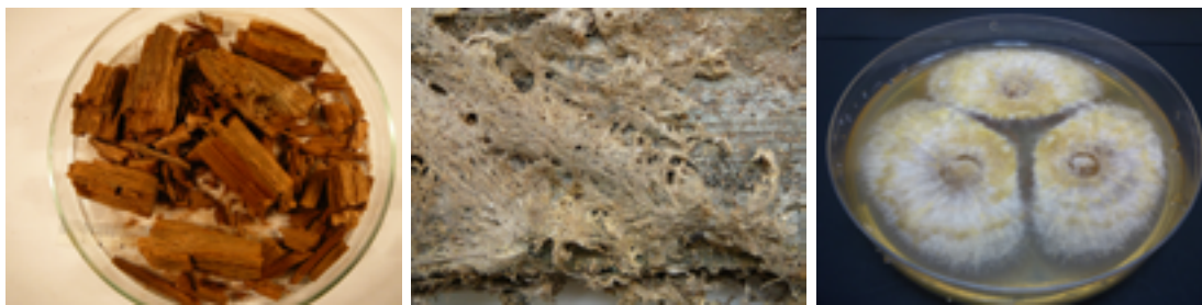
Abb. 1: Beispiele für Probenmaterialien, die bei der vergleichenden Diagnostik eingesetzt wurden; von links: pilzgeschädigtes Holz ohne sichtbare Pilzstrukturen, Oberflächenmyzel auf einer Holzprobe, Reinkultur von Leucogyrophana pinastri in einer Malzextrakt-Agar-Petrischale
