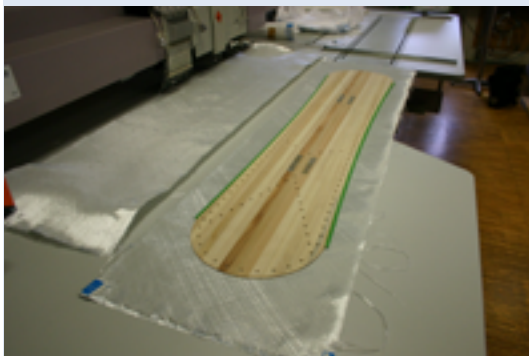
Abb. 1: Einbringen von dreidimensionalen Verstärkungselementen am Beispiel eines Snowboard-Halbzeugs mit Hilfe einer CNC-gesteuerten Stickmaschine
