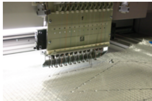
Abb. 1: Einbringen von dreidimensionalen Verstärkungselementen am Beispiel eines Snowboard-Halbzeugs mit Hilfe einer CNC-gesteuerten Stickmaschine
