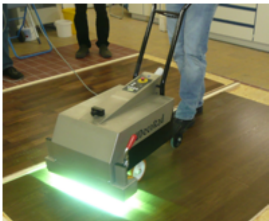
Abb. 2: Herstellen von Parkett-Musterflächen mit der mobilen UV-Strahlereinheit
