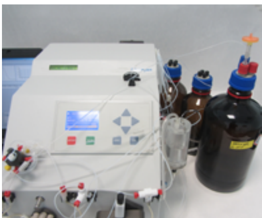
Abb. 1: Analysengerät mit installierter Anreicherungs- zelle, Reagenzgefäßen und Auswerteeinheit
