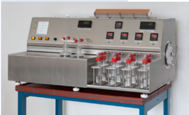
Abb. 1: Prüfapparatur zur Bestimmung der Formaldehydabgabe nach der Gasanalyse-Methode DIN EN 717-2
