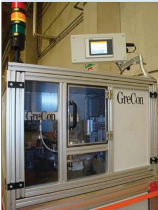
Abb. 1: Apparatur zur Bestimmung der Formaldehydabgabe von Holzwerkstoffspänen
