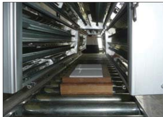
Abb. 2: Aufschmelzen des auf Furnier aufgetragenen Pulverlacks mit keramikbeschichteten IR-Strahlern im Technikum des IHD
