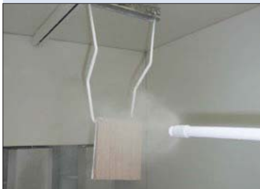
Abb.1: Pulverauftrag auf furnierte Muster mit einer Tribo-Sprühpistole
