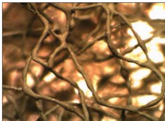
Abb. 1: Kratzmaterialien nach Verfahren A und B gemäß IHD-W-474 (links: Scotch Brite 3M CF-HP 7447+, M 20:1; rechts: Scotch Brite 3M CF-HP 7448+, M 10:1; Fotos Weiss IHD)
