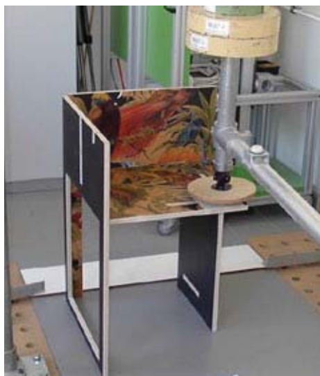
Abb. 3: Falthocker bei Standsicherheitsprüfung
