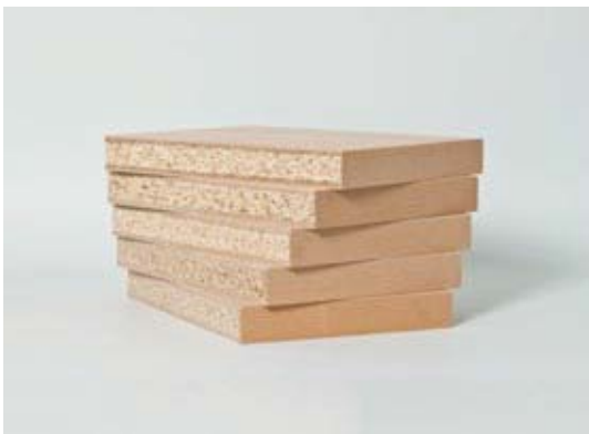
Abb. 2: Beschichtete Spanplattenmuster mit Spanmischungen aus Schneid- und Schlagspänen (Fichte), Dichte 480 \text{ kg/m}^3 , mit Polystyrol (oben), Kork (2. von oben), ohne Füllstoff (Mitte) im Vergleich mit Spanplatte aus Industrie-Mittelschichtspänen ohne Füllstoff mit Plattenrohddichte 480 \text{ kg/m}^3 (2. von unten) und 600 \text{ kg/m}^3 (unten)
