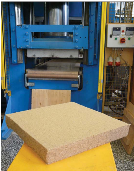
Abb. 1: Holzfaserdämmplatte aus chemisch modifizierten Fasern
