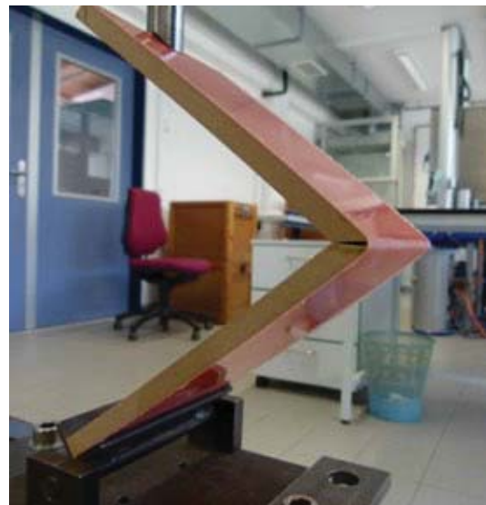
Abb. 1: Druckprüfung eines Eckelementes
