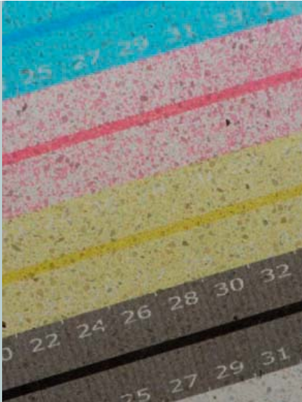
Abb. 1: Entfärbungen des Druckbildes auf einer geschliffenen Betonplatte infolge einer Freibewitterung
