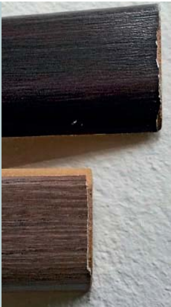
Abb. 1: Abplatzungen nach dem Fräsen von den mit Durchimprägnaten ummantelten Leisten
