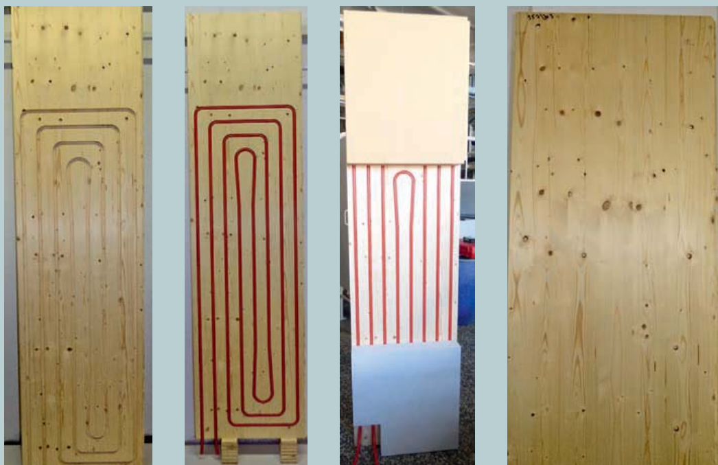
Abb. 2: Gefertigtes Element mit spiralförmiger Rohrverlegung, Größe 2,5 m x 0,62 m, Rohrabstand 8 cm, auf der wandzugewandten Seite mit aufgebrachter Dämmung und Ausschnitt in Mitte zur Darstellung der Verrohrung (von links nach rechts: eingefräste Kanäle; mit eingelegten Rohren; fertiges Element mit Dämmung; raumzugewandte Seite)
