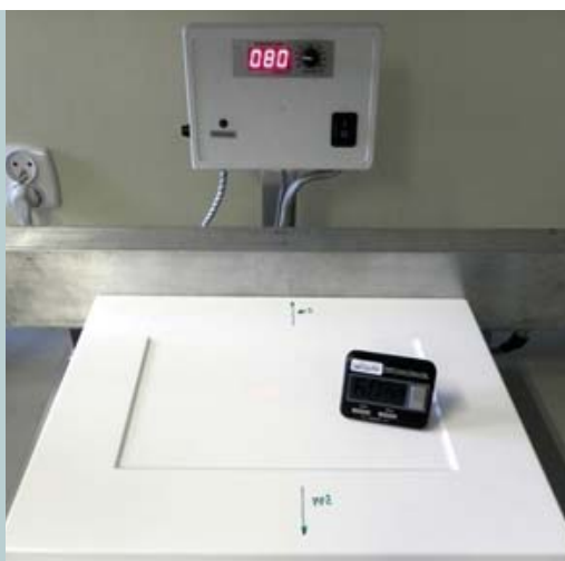
Abb. 3: Prüfung der Beständigkeit gegen Kontakthitze
