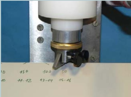
Abb. 1: Adhäsionsprüfung an einer beschichteten Möbelkante
