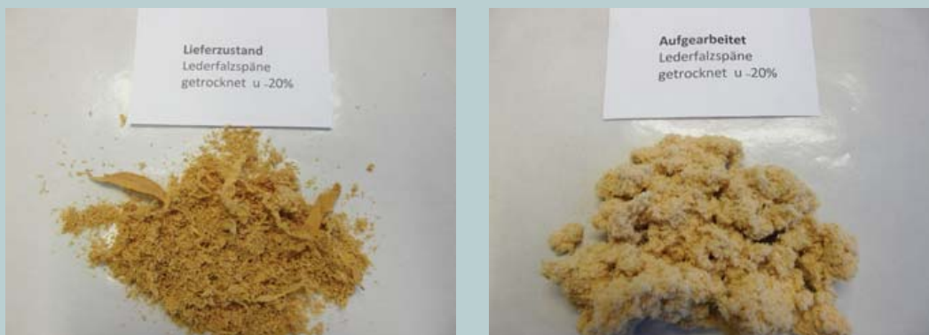
Abb. 1: Lederfalzspäne im Anlieferungszustand (links) und aufbereitet mittels Wirbelstrommühle des IHD (rechts)
